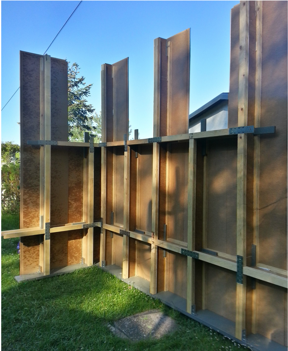
Bewitterungstest der xT-Bauweise mit Stegträgern und Weichfaserplatten von STEICO (nach fünf Monaten)
